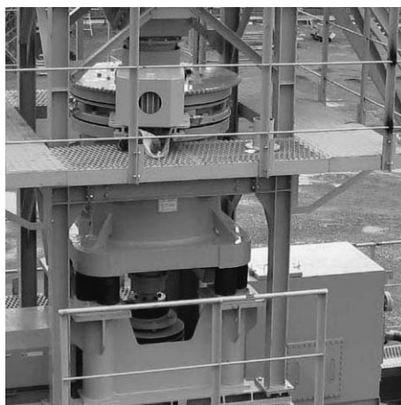
写真2 慣性円錐型磨砕機“ジャイロリック 600”
